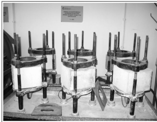
Slika 4. Ispitivanje vodonepropustljivosti Figure 4. Waterpermeability testing
